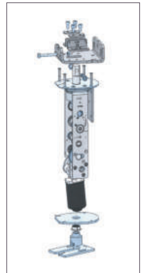
Moteur intégré dans le montant. Les câblages sont réalisés dans nos ateliers.
